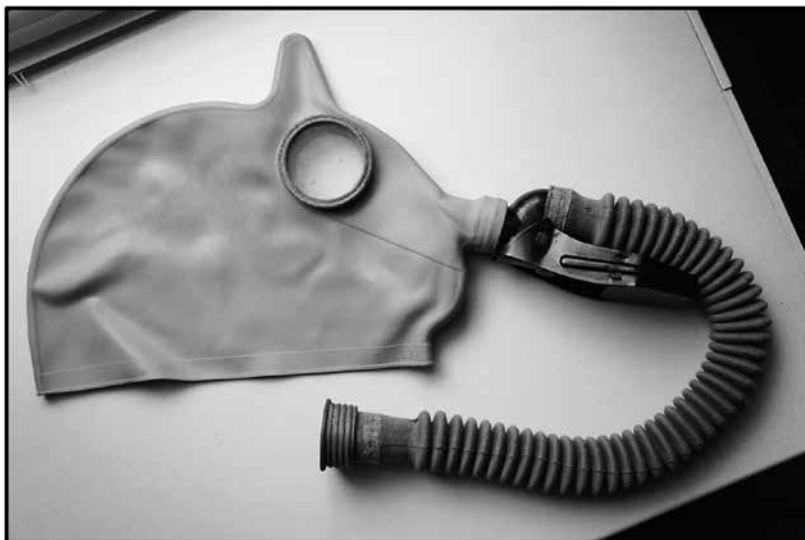
Рис. 1.7. Противогазная маска Ш-1 1935 года выпуска
